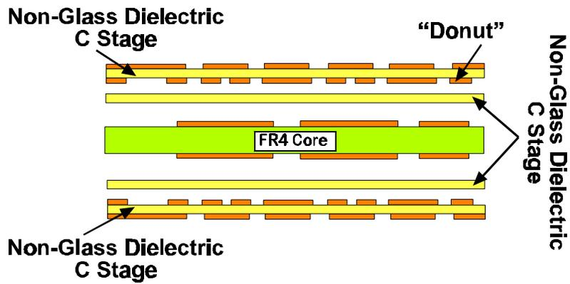
**Fig. 10 Core Cap Lamination**
